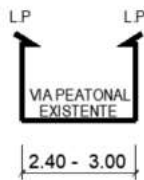
IMAGEN 122: SECCION VIAL 1-1 VIA EXISTENTE
